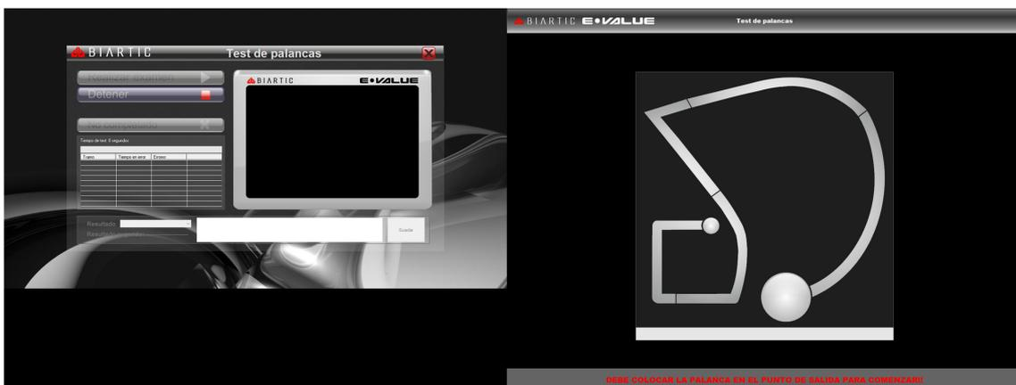
Una vez colocada la palanca en el punto de inicio el examen comienza, indicando que debe seguir por el trazado hasta llegar al punto final (circulo más pequeño), mostrando una barra de progreso que indica el tiempo de examen transcurrido en ambas pantallas. Debajo de la barra de progreso de la pantalla de la notebook se mostraran los errores presentes en cada trazado como así también el tiempo en error acumulado por tramo. Cuando la aguja de la palanca deja
