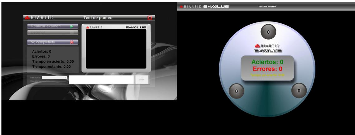
Se muestran unas flechas que giran formando un círculo, dentro se muestra el tiempo restante del test que es de 30 segundos en total, el plato gira a 30 revoluciones por minuto, por lo que en los 30 segundos de test tenemos 15 aciertos como máximo por pulsador.
