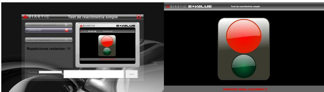
Una vez evaluada la primera reacción, se muestra el tiempo de la reacción debajo del semáforo, y se prosigue con la siguiente prueba presionando el pedal derecho. Esto se hará sucesivamente hasta realizar las 2 primeras pruebas de ensayo más las 10 repeticiones siguientes que si serán evaluadas.
