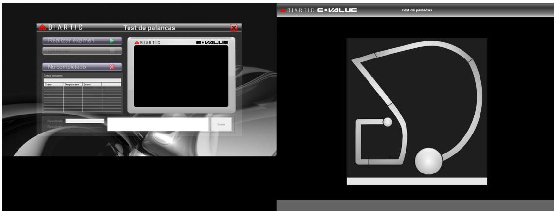
Si el evaluado no colocó la palanca sobre el punto de inicio (circulo de mayor tamaño) el software se lo indicará con un mensaje de error en la parte inferior de la pantalla del GI.
